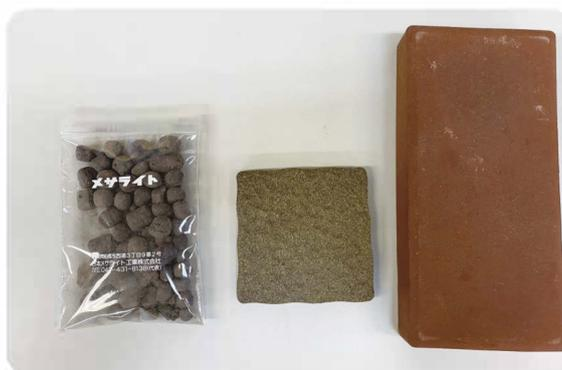
汚泥焼却灰から作られた製品(左から建築骨材原料、タイル、レンガ)
